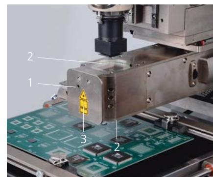
**PLACEMENT AVEC MESURE DE FORCE****Placement motorisé automatique et précis**
