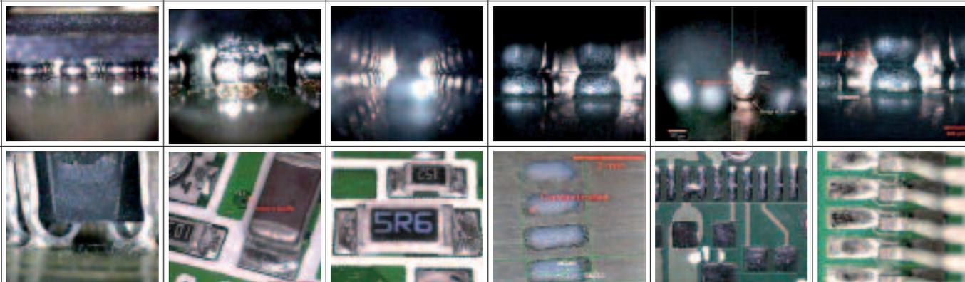
Les joints de soudure masqués et les faibles hauteurs sous capot font de l'inspection des BGA en post-production une tâche extrêmement difficile à accomplir. La recherche d'une solution fiable et rentable pour le contrôle optique des BGA a abouti au développement d'un système d'inspection hautement polyvalent, le Flexia BGA.
