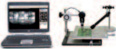
Remplacer l'optique BGA par le zoom optique standard inclus et transformer le système Flexia en un microscope vidéo haute résolution pour l'inspection visuelle des cartes câblées, soudures, plages d'accueil, composants, etc.
