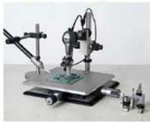
Remplacer l'optique BGA par le zoom optique standard inclus et transformer le système Flexia en un microscope vidéo haute résolution pour l'inspection visuelle des cartes câblées, soudures, plages d'accueil, composants, etc.
