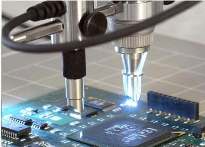
Le système d'inspection Flexia BGA se compose du microscope Basic Flexia, du zoom optique BGA à faible ouverture et vision latérale avec éclairage à LED intégré, d'un éclairage de fond externe, d'un macro-zoom optique 1-60x supplémentaire pour l'inspection des CMS/cartes de circuit imprimé et d'un statif à hauteur réglable conçu spécialement.
