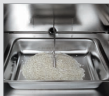
Affichage de la température de l'échantillon par sonde PT 100 (VD | VDL | FDL | FP | M | ED | FD | FED)
