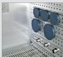
Passages de câbles variables pour connexions avec de nombreux instruments de mesure
