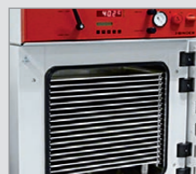
Etuve de séchage sous vide avec clayettes spéciales pour un grand nombre d'échantillons particulièrement plats
