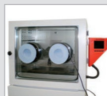
Chambre climatique avec porte en verre transparente et passages manuels
