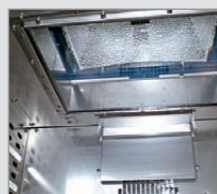
Etuve de séchage sécurisée avec lampe UV pour tests de résistance aux UV
