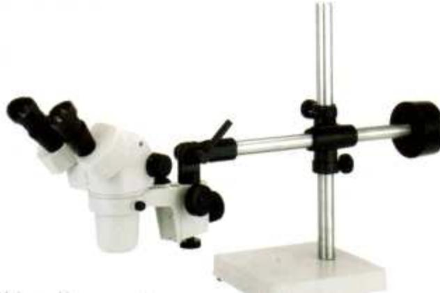
Binoculaire / Stéréo-microscope à 45°, grossissement X 6.7 à X 50 avec champ de 34.3 mm à 3.6 mm, facteur de zoom 7.46:1. Potence universelle UN-S100 à grand débattement (564 mm max. axe potence / axe optique) avec support binoculaire à crémaillère. Distance de travail 108 mm, ajustement inter-pupillaire 52 à 75 mm, ajustement dioptries + / - 7.2 D sur chaque oculaire.
